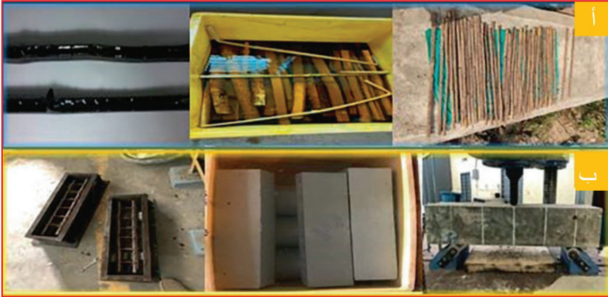
شكل 3,2: كمرات خرسانية مسلحة بالخيّزان: (أ) معالجة الخيّزان، (ب) صب واختبار الكمرات الخرسانية المسلحة بالخيّزان.
