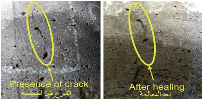
الشكل 7.8 الخرسانة البكتيرية المركبة قبل الالتئام وبعده
