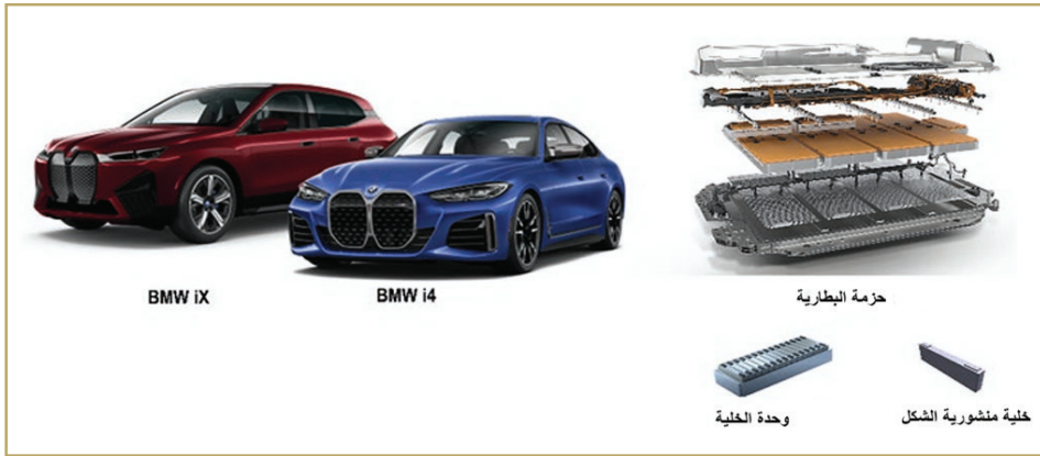
الشكل 8.10 بنية خلية الجيل الخامس (Gen5) من بي إم دبليو، الوحدة، وحزمة البطارية
